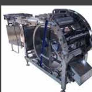
ЛИНИЯ МЕХАНИЧЕСКОЙ ПРОБИВКИ ЯСТЫКОВ ИКРЫ
